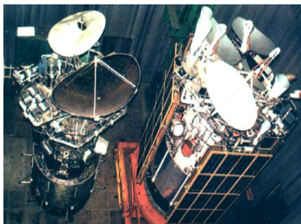
КА «Галс» (без панелей СБ) и «Экспресс» на стадиях изготовления в НПО ПМ
