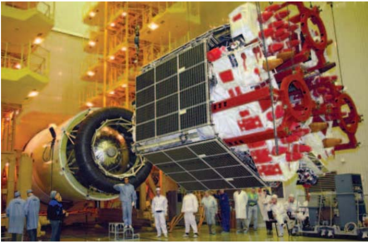
Стыковка блока из 3 КА «Глонасс-М» с разгонным блоком перед запуском на космодроме Байконур
