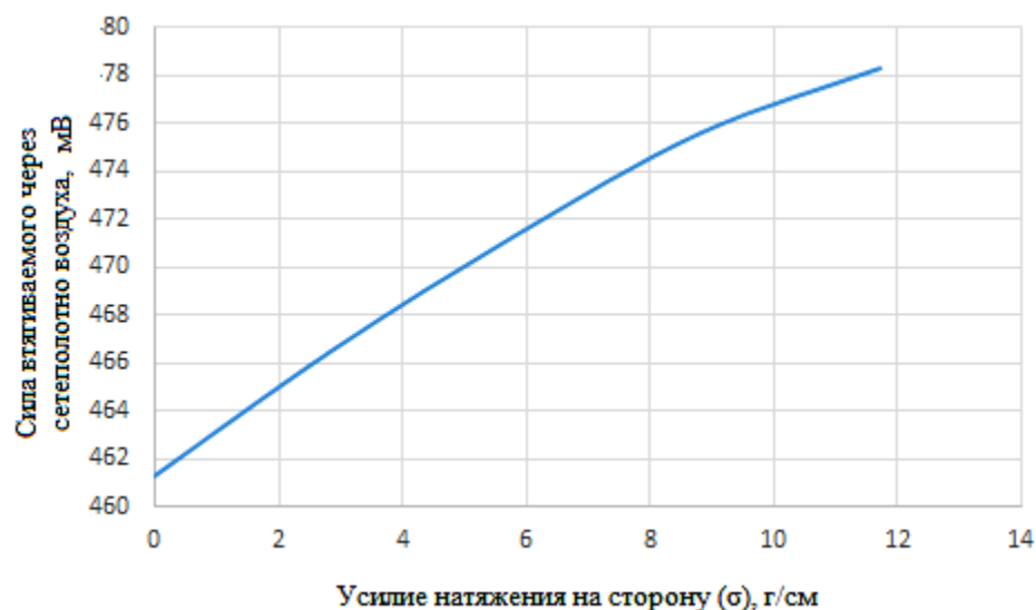
Рис. 3. Зависимость силы втягиваемого воздуха через поверхность сетеполотна от усилия натяжения, приложенного к сетеполотну
