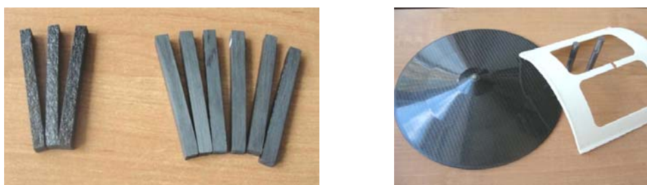
Рис. 11. Образцы для изучения высокоскоростного фрезерования композитов на основе углепластиков: a – образцы для испытаний; б – изделия
