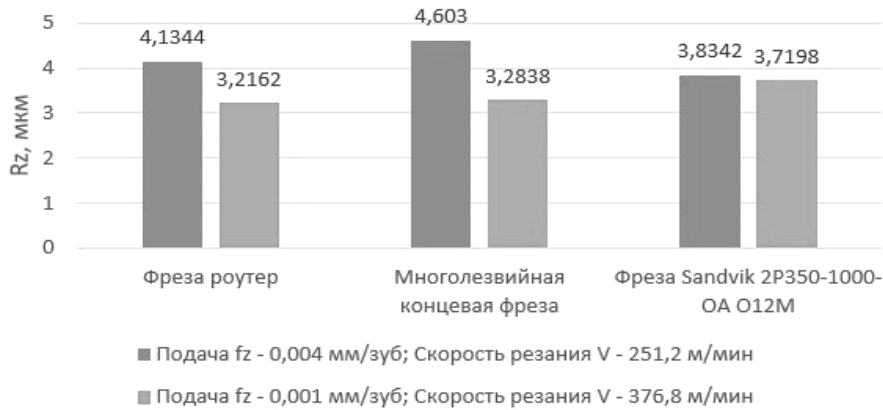
Рис. 14. Результаты замеров параметра Rz после сравнительных испытаний
