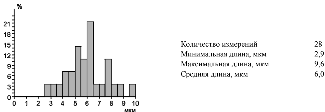
Рис. 12. Размер зерна в покрытии, полученном после альфирования в вакууме
