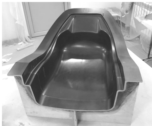
Рис. 3. Оснастка из углепластика Fig. 3. Carbon fiber composite rigging
