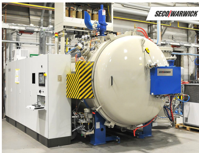
Рис. 3. Вакуумная печь SECO/WARWICK 10 VPT-4050/48 HV
