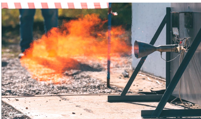
Рис. 7. Огневые испытания РДМТ
