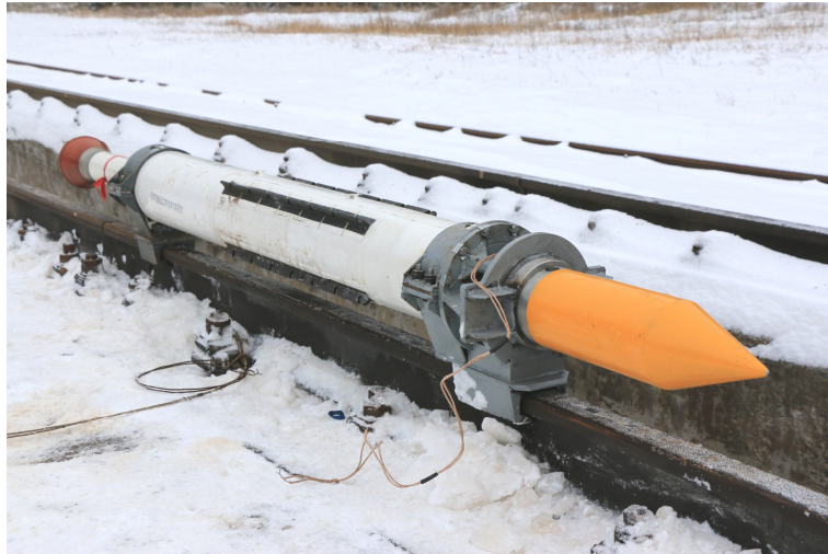
Рис. 1. Изображение монорельсовой трековой каретки с модельным объектом испытания. Состав: передний башмак с кронштейном для крепления модельного объекта испытания; РДТТ; задний башмак
