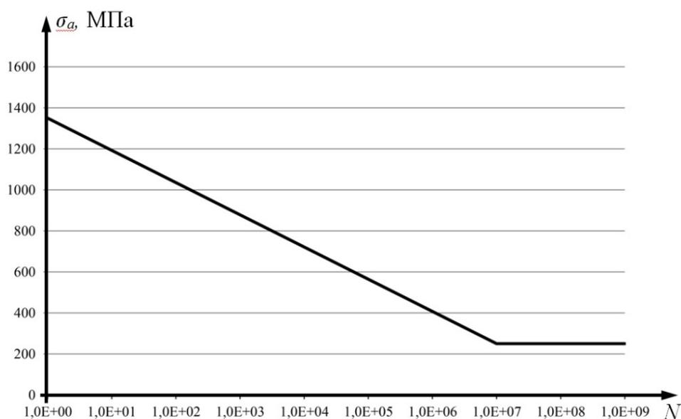
Рис. 4. Пример кривой Веллера в логарифмической шкале
