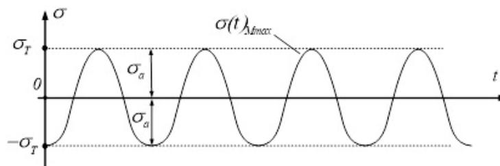
Рис. 3. Симметричный цикл нагружения контактного кольца
