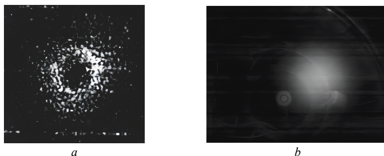
Рис. 9. Свечение на положительно смещенном электроде, полученное в [58] (а) и в лаборатории МАИ (б)
