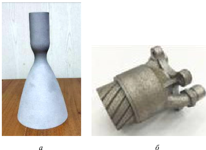
Рис. 2. Напечатанные камера (а) и смесительная головка ракетного двигателя (б)
