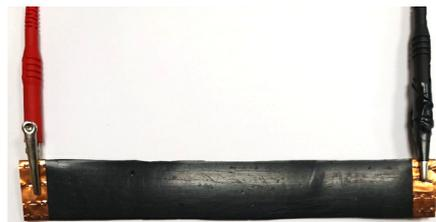
Рис. 5. Гибкий тензорезистивный элемент из нанокomпозиционного материала
