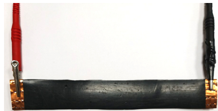
Рис. 5. Гибкий тензорезистивный элемент из нанокomпозиционного материала
