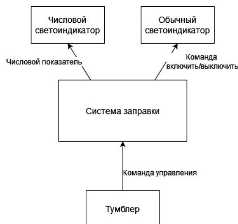
Рис. 1. Упрощённая модель взаимодействия пульты управления с системой заправки
