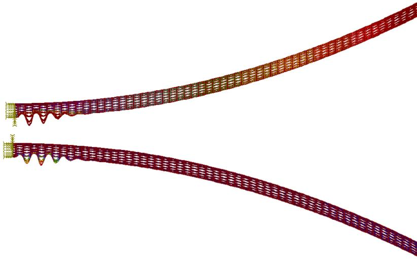
Рис. 16. Формы потери устойчивости сетчатой спицы с 16 спиральными ребрами одного семейства под действием собственного веса в исходном (вверху) и перевернутом положениях
