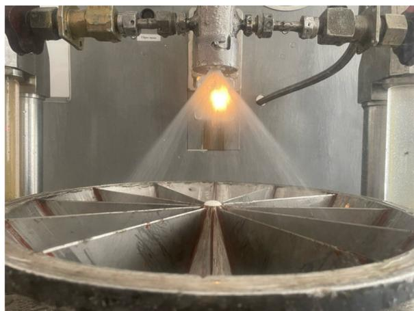
Рис. 9. Пролив форсунок
