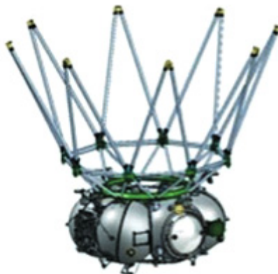
Рис. 2. Ферменная конструкция разгонного блока типа «ФРЕГАТ»
