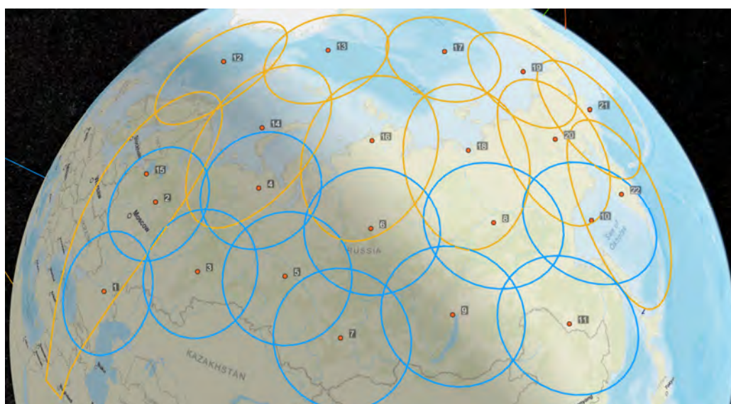
Рис. 4. Зона покрытия полезной нагрузки Ку-диапазона из апогея
