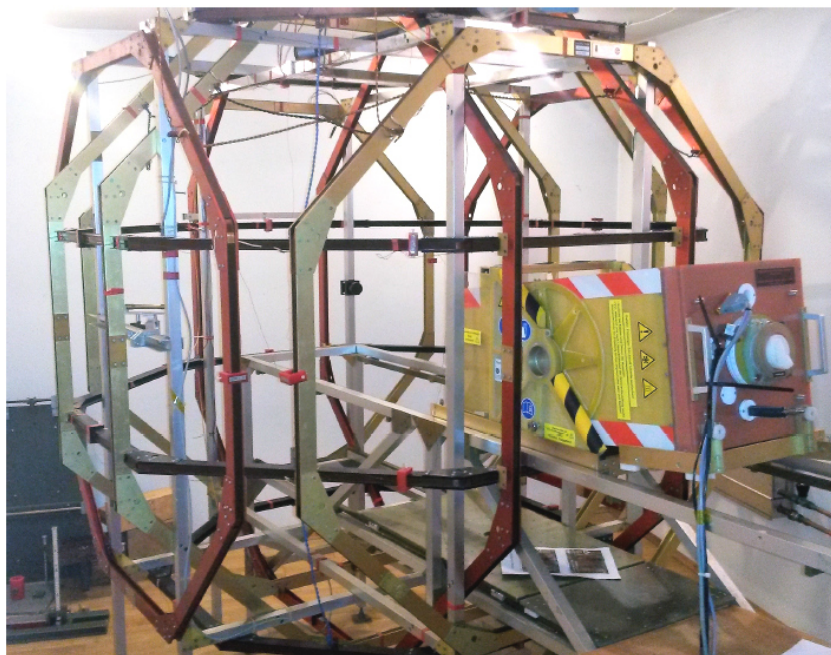
Рис. 3. Пример внешнего вида стенда магнитных испытаний [6], где применяется система колец Браунбека, испытуемый и эталонный магнитометры расположены на поворотном столе в термокамере (жёлтый ящик), термокамера устанавливается в центр кольцевой системы при помощи каретки
