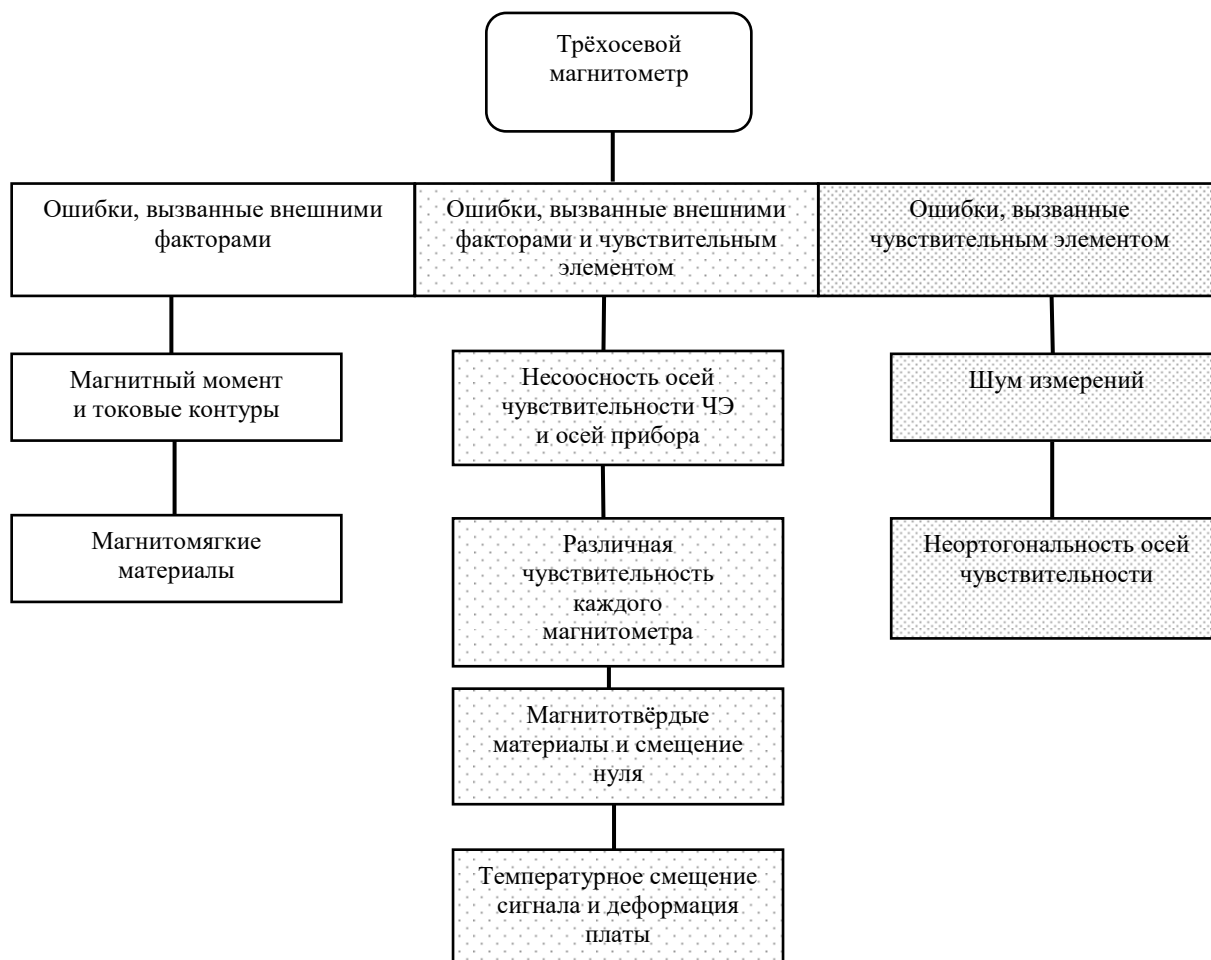
Рис. 2. Ошибки, влияющие на показания АМР магнитометра
