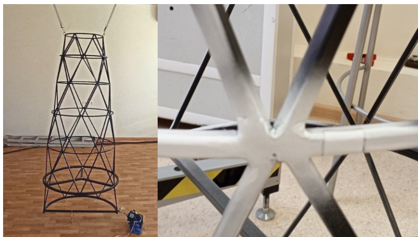
Рис. 1. Макет рамы телескопа на подвесках и покраска конструкции для выделения места снятия данных
