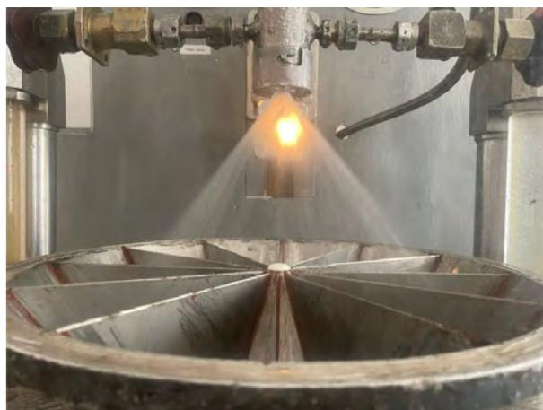
Рис. 9. Пролив форсунок
