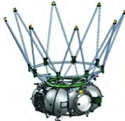
Рис. 2. Ферменная конструкция разгонного блока типа «ФРЕГАТ»
