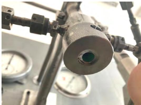
Рис. 8. Установленная втулка с форсункой на стенде
