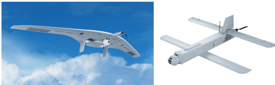
Рис. 5. БАС СКАТ 350М концерна «Калашников» и Куб-Э (управляемый барражирующий боеприпас)
