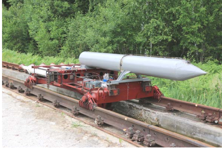
Рис. 1. Фотография трековой двухрельсовой каретки 33AB-NO505 № 2 с башмаками для скольжения по рельсам и моделью объекта испытания. Связка из пяти РДТТ жестко закреплена в задней части каретки
