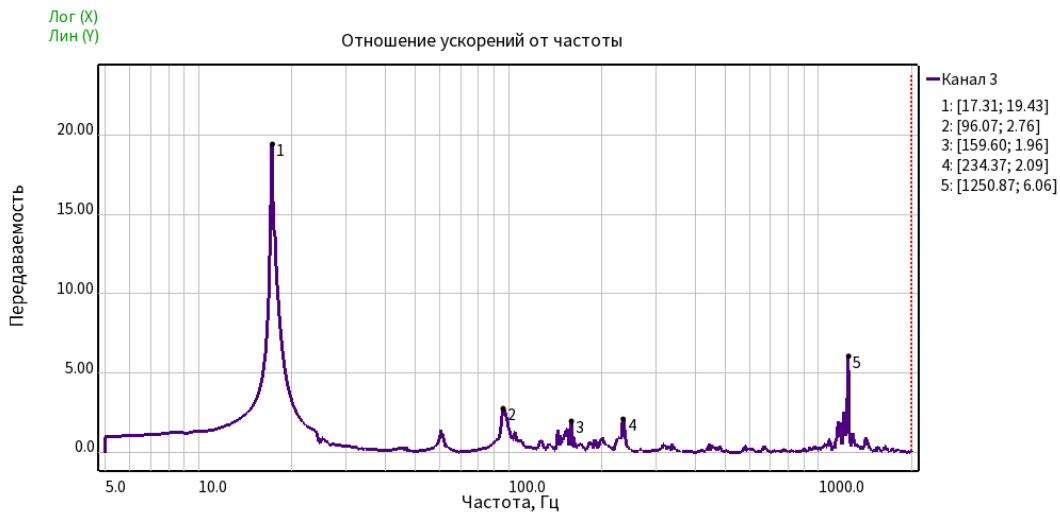
Рис. 3. Зависимость динамического коэффициента передачи (резонансного усиления) от частоты вынужденных колебаний
