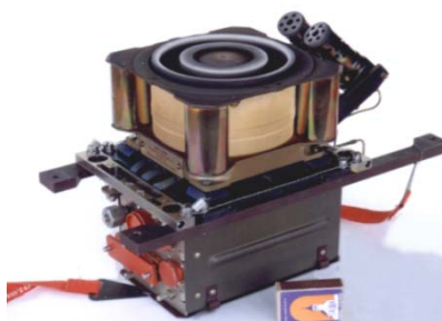
Рис. 1. Блок коррекции довыведения на базе СПД-100В
