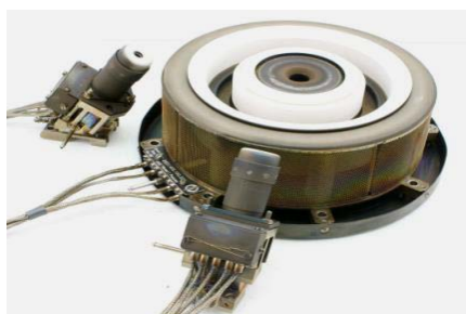
Рис. 3. Двигатель довыведения СПД-140Д с катодами
