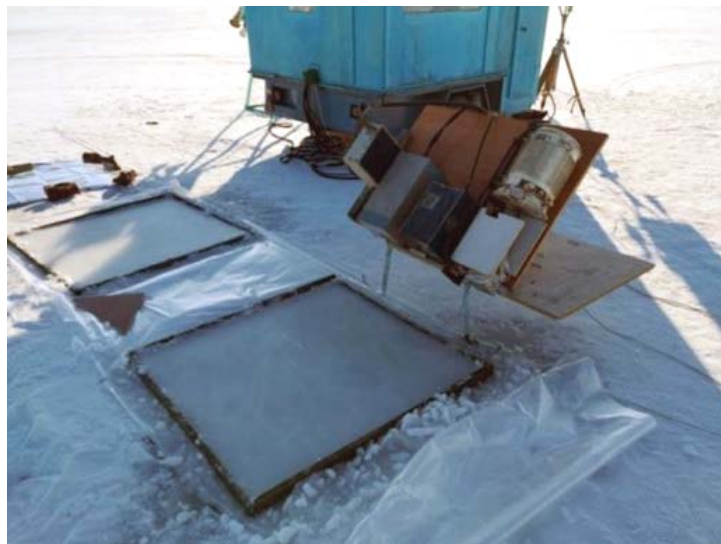
Рис. 2. Фотография установки для измерения фактора потерь искусственной наледи
