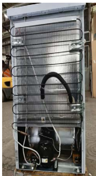
Рис. 1. Расположение мест крепления термодатчиков на конденсаторе холодильника
