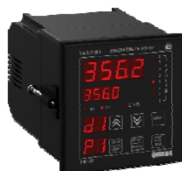
Рис. 4. Термосопротивление градуировки 50М [5] (а); ТРМ 138 восьмиканальный регулятор с RS-485 [6] (б)
