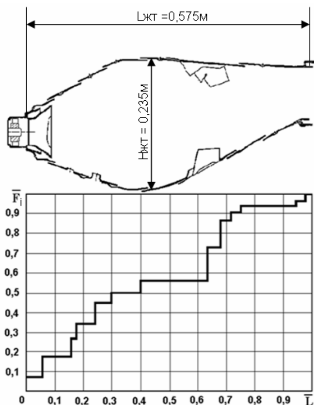
Рис. 5. Распределение воздуха по длине жаровой трубы
