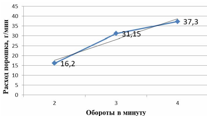
Рис. 2. График зависимости расхода порошка от частоты вращения диска
