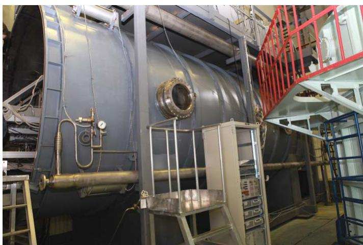
Рис. 11. Внешний вид вакуумной камеры стенда ГВУ-60
