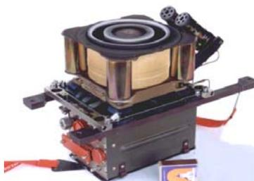
Рис. 1. Блок коррекции довыведения на базе СПД-100В
