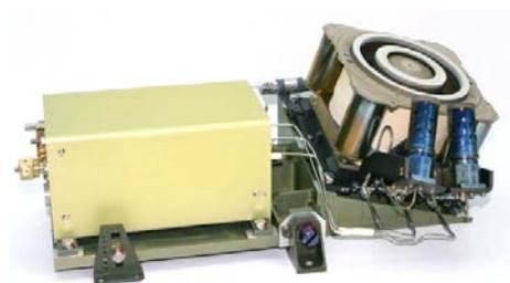
Рис. 2. Блок коррекции орбиты на базе СПД-100В
