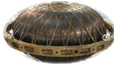
Рис. 6. Ксеноновый бак высокого давления
