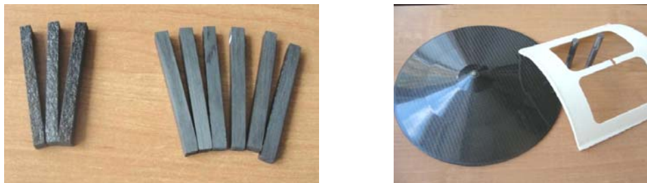
Рис. 11. Образцы для изучения высокоскоростного фрезерования композитов на основе углепластиков: а – образцы для испытаний; б – изделия
