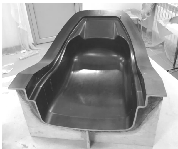
Рис. 3. Оснастка из углепластика
