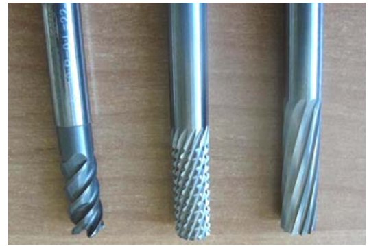
Рис. 2. Образцы новых конструкций твердосплавных фрез для проведения испытаний
