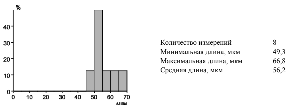
Рис. 11. Толщина слоя покрытия, полученного после альфирования в вакууме
