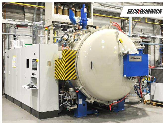
Рис. 3. Вакуумная печь SECO/WARWICK 10 VPT-4050/48 HV
