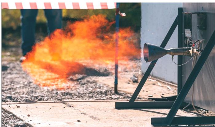
Рис. 7. Огневые испытания РДМТ
