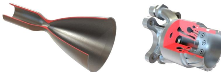
Рис. 1. 3D-модели корпуса камеры и смесительной головки
