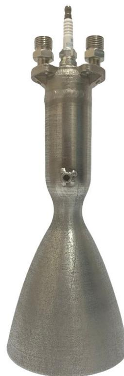
Рис. 5. Камера РДМТ в сборе
