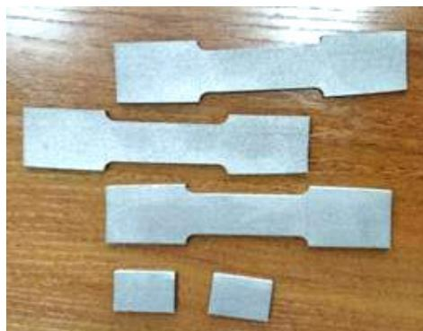
Рис. 1. Образцы для механических испытаний
