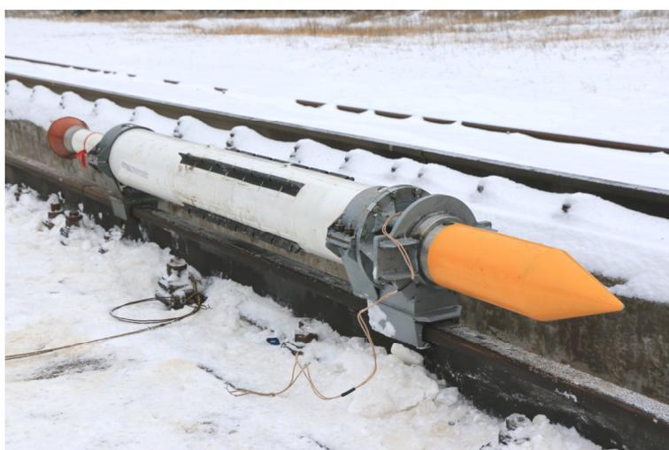
Рис. 1. Изображение монорельсовой трековой каретки с модельным объектом испытания.
