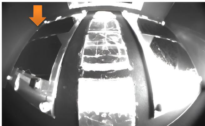
Рис. 3. Фотография разряда на БС технологического спутника HORYU-IV [23]
