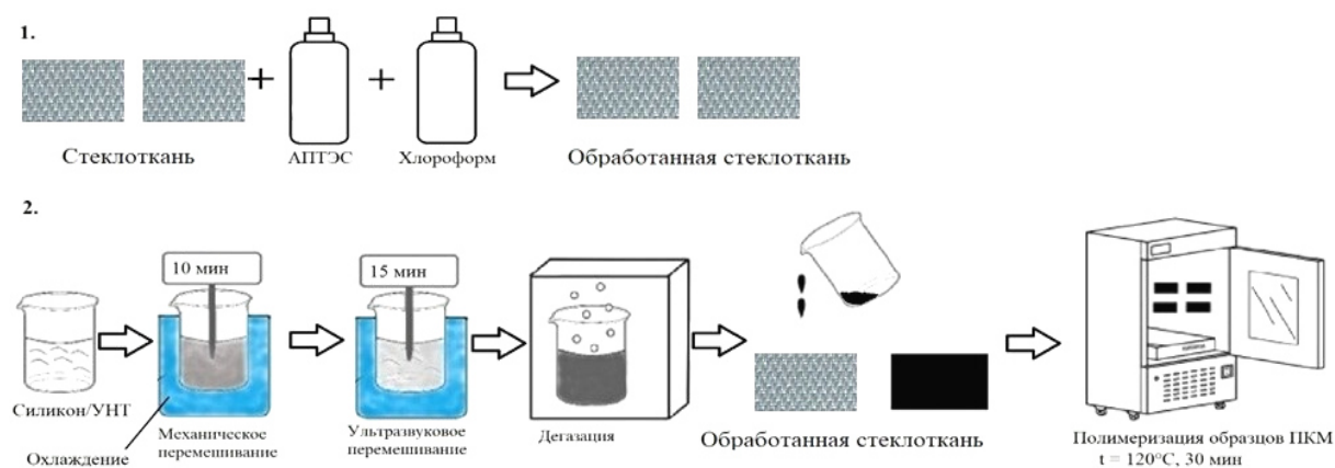
Рис. 1. Технологическая схема изготовления гибкого тензорезистивного элемента из нанокompозиционного материала
