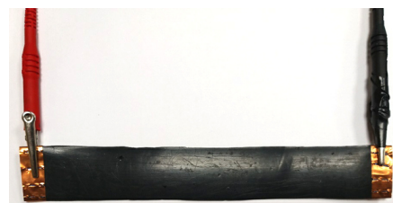
Рис. 5. Гибкий тензорезистивный элемент из нанокomпозиционного материала
