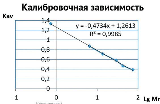
Рис. 2. Типичный вид градуировочной зависимости CO калибровочных растворов (GelFiltrationCalibrationKit LMW) и CO «Даларгина»
