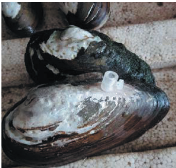
Рис. 7. Моллюск с наклеенным миниатюрным держателем волоконно-оптического зонда Fig. 7. The mussel with miniature fiber-optic probe holder glued
