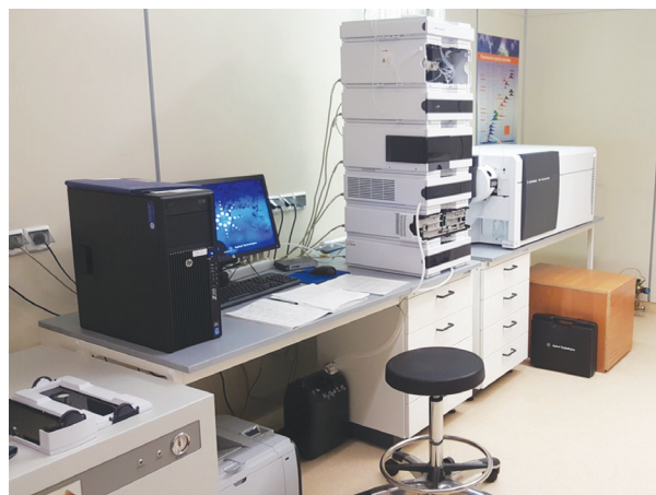
Рис. 1. Референсная система ВЭЖХ-МС для определения витаминов (фото автора, лаборатория НМИЦ им. В. А. Алмазова, Санкт-Петербург)
