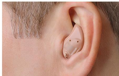
Рис. 25. Внешний вид слухового аппарата, установленного в ушном проходе
