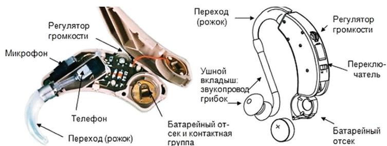
Рис. 24. Общий вид и основные конструктивные узлы слухового аппарата
