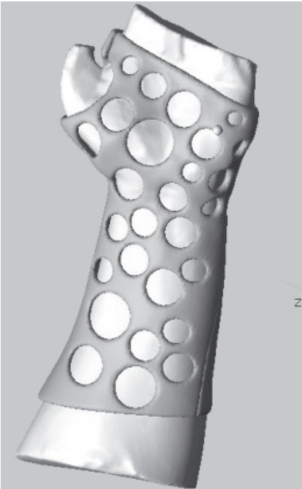
**Рис. 4.** Моделирование отверстий в программе Geomagic Freeform Plus
