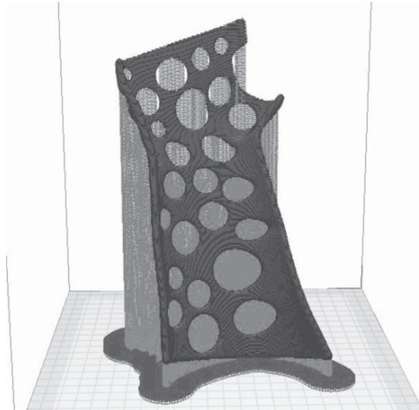
**Рис. 5.** Подготовка модели к печати в программе Cura 4.0
