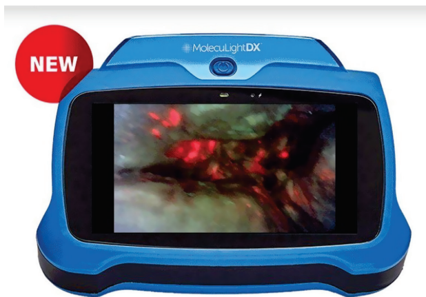
Рис. 3. Устройство MolecuLight DX™ той же компании способно обнаружить большинство видов бактерий, продуцирующих порфирин, при повышенной бактериальной нагрузке ( >10^4 КОЕ/гр)
