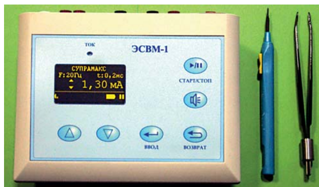
Рис. 1. Электростимулятор ЭСВМ-1 для интраоперационного визуального нейромониторинга
