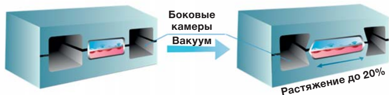
Рис. 1. Принципиальное устройство и варианты «лёгкого-на-чипе»: а — структура ацинуса лёгких человека; б — схемы разработанных на сегодняшний день микрофлюидных устройств и варианты LoC (слева направо: одноканальное — Y. Zhu и соавт., 2022 [6]; двухканальное — D. Huh и соавт., 2010 [7], трёхканальное — A. Varone и соавт., 2021 [8]); в — имитация дыхательных движений с помощью отрицательного давления в боковых каналах LoC (по D. Huh и соавт., 2010 [7]). ЛА — лёгочная артерия; ЛВ — лёгочная вена; ГВ — гладкомышечные волокна; АМе — альвеолярный мешочек; ЛК — лёгочные капилляры; AI — альвеолоцит I типа; AII — альвеолоцит II типа; AM — альвеолярный макрофаг.
