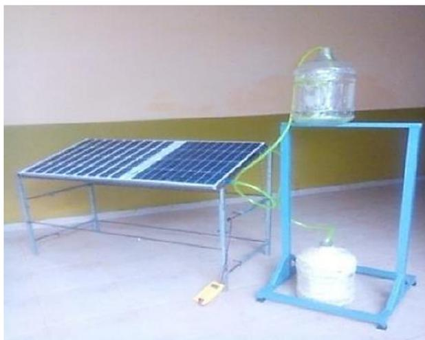
Рис. 1. Экспериментальная установка пассивного водяного охлаждения [7]
