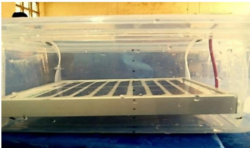
Рис. 2. Установка водяного погружного охлаждения [6]
