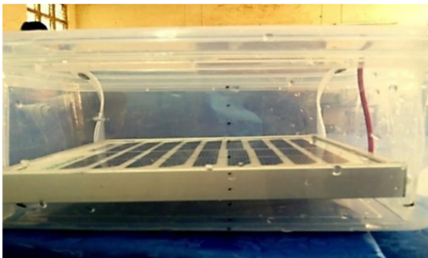
Рис. 2. Установка водяного погружного охлаждения [6]
