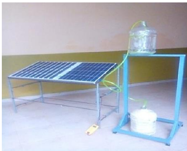
Рис. 1. Экспериментальная установка пассивного водяного охлаждения [7]
