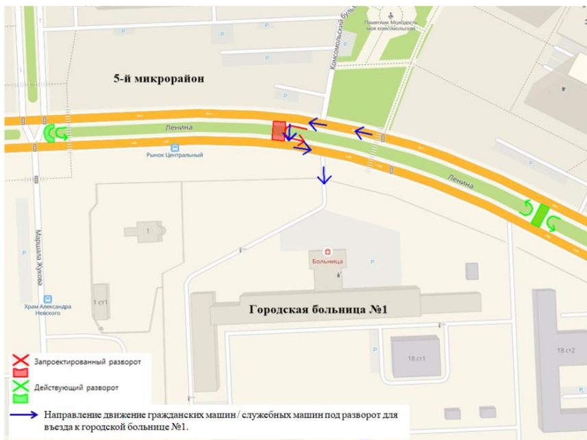
Рис. 4. Схема запланированного разворота на перекрестке улиц Ленина – Маршала Жукова в г. Нижневартовске
