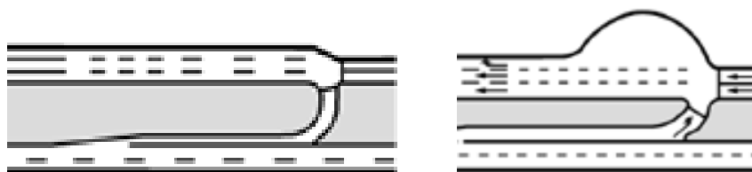
Рис 1. Схемы пересечений улиц с отнесенным левоповоротным движением [4]
