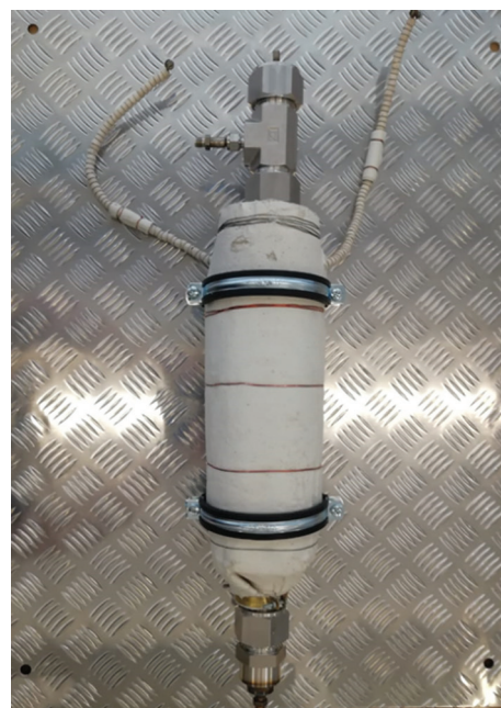
Рис. 1. Газовый реактор каталитического пиролиза метана
