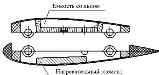
Рис. 1. Сечение экспериментальной модели
