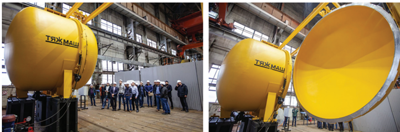
Рис. 2. Испытательный стенд системы контроля и обеспечения герметичности
