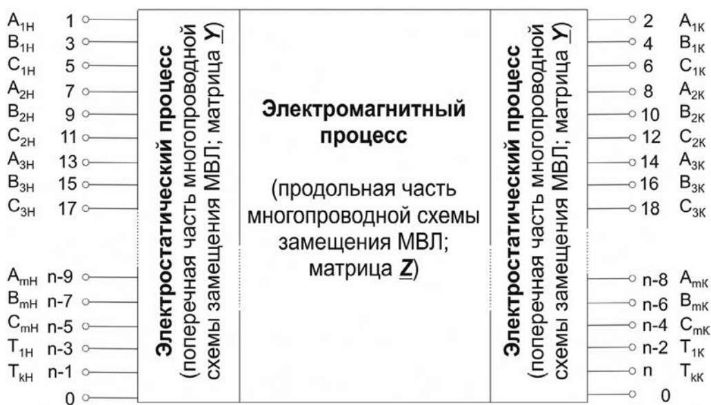
Рис. Модель МВЛ в виде обобщенной n -полюсной многопроводной схемы замещения для m -цепной МВЛ с k -грозозащитными тросами
