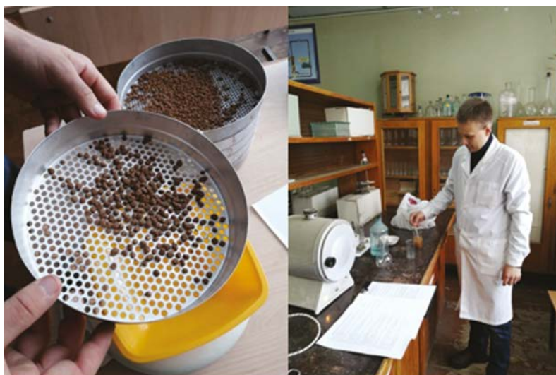
Рис. 2. Определение гранулометрического и химического состава глины
