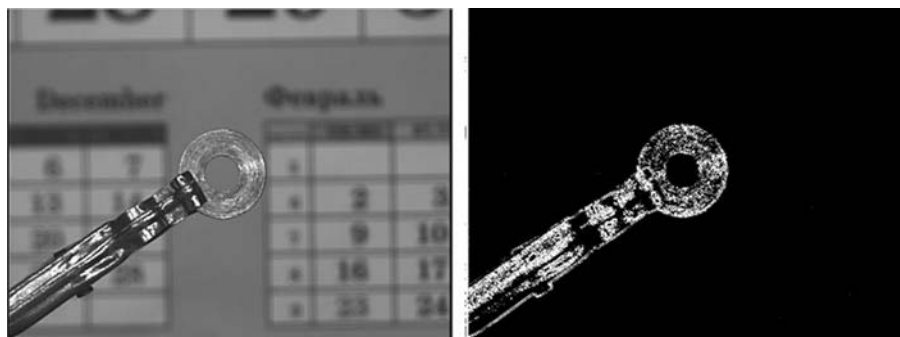
Рис. 2. Исходное и бинарное изображения объекта, полученное с помощью Лапласиана
