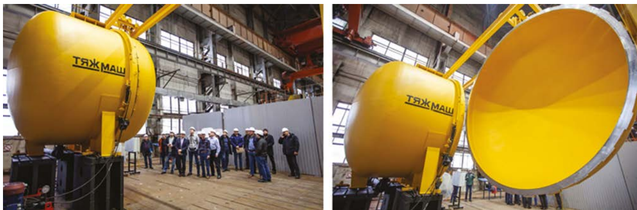
Рис. 2. Испытательный стенд системы контроля и обеспечения герметичности
