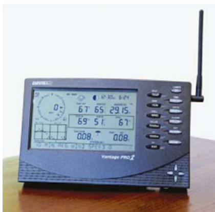
Рис. 1. Метеостанция Davis Vantage Pro2
