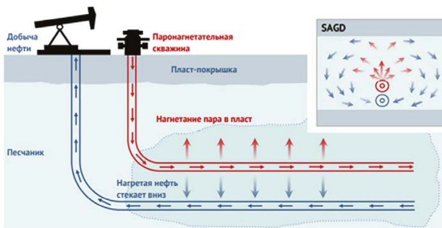
Рис. Паротепловая обработка скважин
