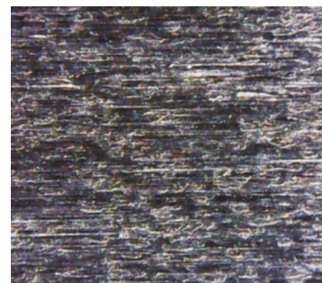
Рис. 5. Снимок обработанной поверхности титана ВТ-6 (увеличение \times 500 )
