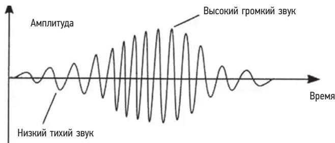
Рис. 2. Графическое отражение достижения порогового значения уровня звука [3]
