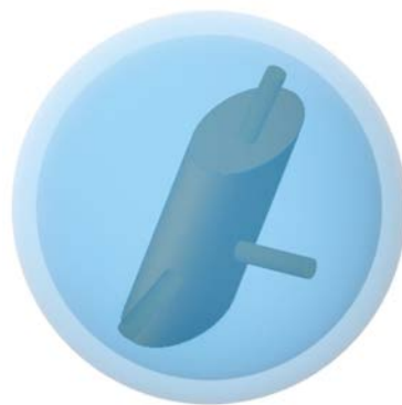
Рис. 2. Сферическая полость, заполненная вязкой жидкостью с установленным демпфером
