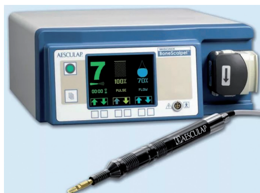
Fig. 1. Ultrasonic scalpel Misonix BoneScalpel
