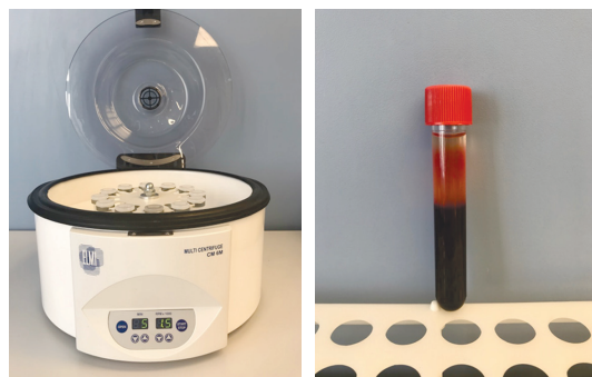
图. 2. 用于制备富含血小板自本血浆的多功能离心机CM 6M和实验室试管
