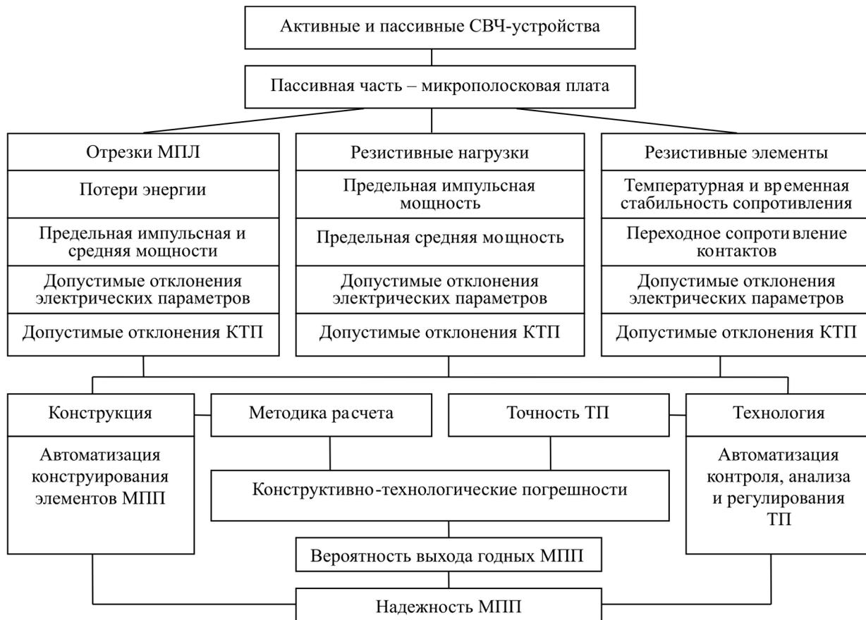
Рис. 1. Основные технические характеристики элементов ПЧ СВЧ-устройств и факторы, влияющие на качество и надежность МПП
